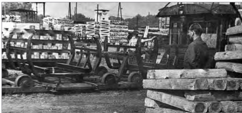
Wózki impregnacyjne czterokółkowe do przewozu drewna, ok. 1975
